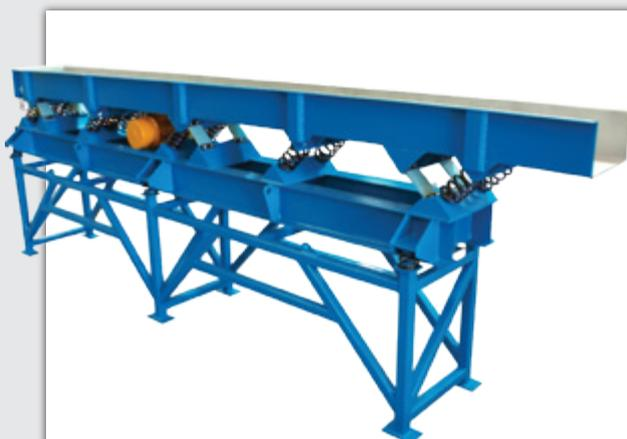
São utilizados no transporte de diversos tipos de materiais atingindo distâncias até 25 metros numa única calha, porém as capacidades são reduzidas quando comparadas ao modelo TMC. Trabalham em regime ressonante tendo como motorização 02 motovibradores situados na parte traseira e diversos jogos de molas planas em conjunto com molas helicoidais que auxiliam na transmissão de movimentos ao longo do comprimento total da calha.
