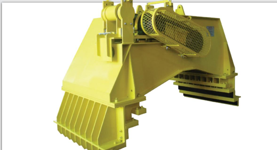
O Vibrador de Vagão é um equipamento robusto e especialmente projetado para exercer a tarefa de colaborar no descarregamento e/ou compactação de cargas em vagões de trem. É composto de estrutura metálica reforçada, um motor elétrico com base de fixação apoiada sobre coxins especiais, um conjunto de polias que acionam um eixo desenvolvido para vibrar através de massas inerciais excêntricas.
