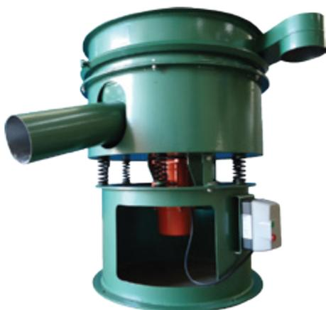
São empregadas na classificação e separação de diversos tipos de produtos tanto em estado líquidos, pastosos, lodosos, pós ou granulados. Tem possibilidade de classificação em até 5 frações com 4 armações de telas sobrepostas. Geralmente são máquinas aplicadas em pequenas e médias capacidades com classificação em diversas malhas com aberturas de 4 - 0,06 mm (7 a 400 mesh).
