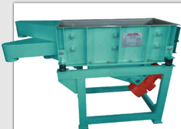
Este tipo de peneira aplica-se na classificação de diversos tipos de produtos em até 04 frações, podendo ser utilizados telas ou chapas perfuradas. Podem ser equipadas quando necessário com sistema de limpeza tipo no blind ou correntes e regulador de camada de fluxo.
