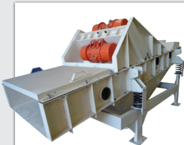
São confeccionadas com carcaças robustas para serviços pesados, geralmente são utilizadas nas Siderúrgicas, Fundições, Minerações e Pedreiras. Aplicadas em grandes capacidades, dotadas de telas especiais com acionamento através de motovibradores ou eixos excêntricos.
