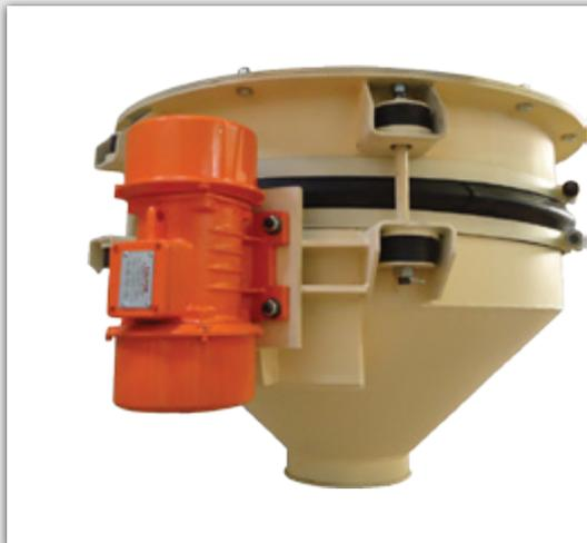
Tem como função quando acoplados nos silos e moegas, descarregar materiais com fluxo constante e uniforme. Quando em operação o material contido internamente sofre movimentos por toda a seção do silo eliminando a formação de pontes devido a resistência interna do material. Também são eliminados os problemas que ocorrem com a formação de chaminés onde apenas a parte de material contida no silo tende a escoar.
