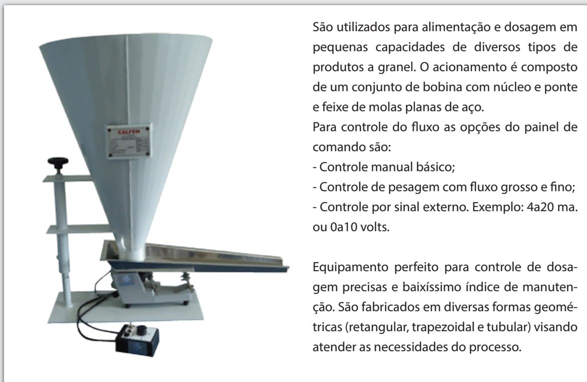
São utilizados para alimentação e dosagem em pequenas capacidades de diversos tipos de produtos a granel. O acionamento é composto de um conjunto de bobina com núcleo e ponte e feixe de molas planas de aço.
