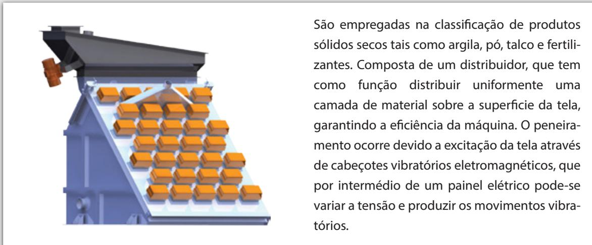
São empregadas na classificação de produtos sólidos secos tais como argila, pó, talco e fertilizantes. Composta de um distribuidor, que tem como função distribuir uniformemente uma camada de material sobre a superfície da tela, garantindo a eficiência da máquina. O peneiramento ocorre devido a excitação da tela através de cabeçotes vibratórios eletromagnéticos, que por intermédio de um painel elétrico pode-se variar a tensão e produzir os movimentos vibratórios.
