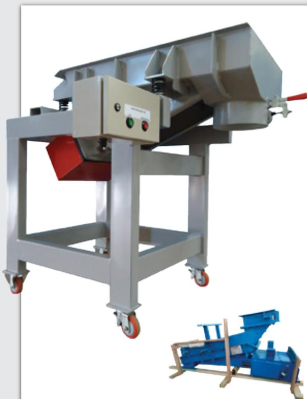
São utilizados para alimentação e dosagem em pequenas e médias capacidades de diversos tipos de produtos a granel. O acionamento é composto de um conjunto de bobina com núcleo e ponte e feixe de molas planas de aço. Para controle do fluxo as opções do painel de comando são:
