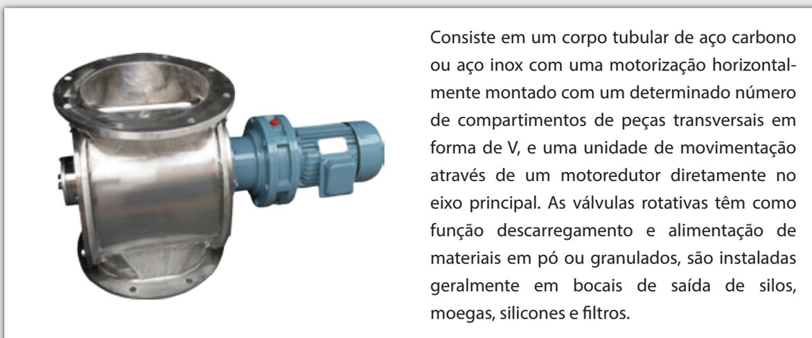
Consiste em um corpo tubular de aço carbono ou aço inox com uma motorização horizontalmente montado com um determinado número de compartimentos de peças transversais em forma de V, e uma unidade de movimentação através de um motoredutor diretamente no eixo principal. As válvulas rotativas têm como função descarregamento e alimentação de materiais em pó ou granulados, são instaladas geralmente em bocais de saída de silos, moegas, silicones e filtros.
